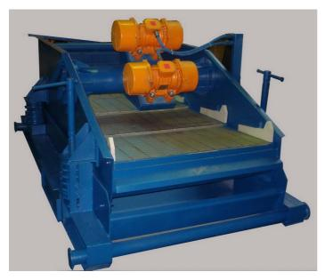
Сито вибрационное с линейными колебаниями для очистки глинистого раствора от выбуренной породы при бурении нефтяных и газовых скважин. В конструкции вибросита применены 4-ре кассеты на жестком каркасе. Крепление кассет осуществляется клиньями. Угол наклона вибрирующей рамы регулируется от +3° до -5° с помощью регулировочных винтов. На виброузлах вибросита установлены вибродвигатели производства итальянской компании ITALVIBRAS MVSI 15/2410 E-S02 или CDX 15/2410-G/D.
